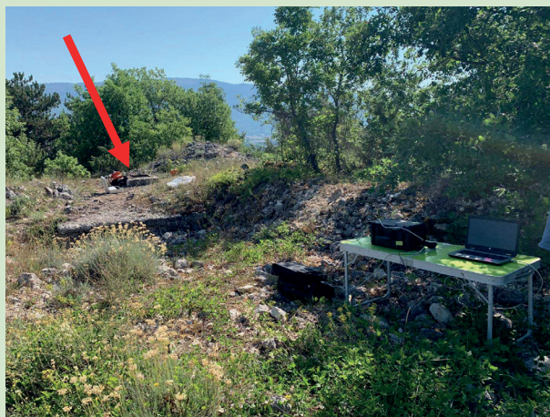
Fig.2: Una tipica situazione in un'adduttrice che attraversa l'Appennino Centrale: una stazione di misura per estemporanee prove di campo (in basso a destra) in corrispondenza di un punto di accesso (evidenziato dalla freccia rossa)
