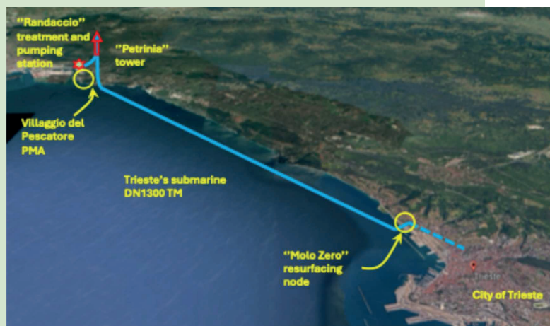
Fig.3: L'adduttrice sottomarina DN1300, gestita da AcegasApsAmga SpA (gruppo Hera) a servizio della città di Trieste
